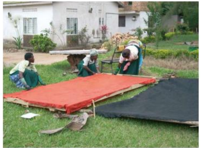
9. Le tissu terminé est tendu sur un châssis. Il est ensuite contrecollé sur un support non tissé en vue de former un revêtement mural de haute qualité.
