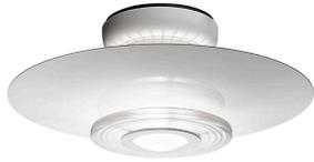
Plafonnier à lumière réfléchi et diffuse. Réflecteur moulé en aluminium recouvert d'un vernis poudre coloris blanc. L'appareil est équipé d'un support spécial en acier moulé qui permet une diffusion de la la lumière par rayons. Diffuseur frontal en verre pressé sablé et lentille en verre transparent pressé. Attache plafond en aluminium moulé sous pression, recouvert d'un vernis liquide coloris noir opaque. Rosace en aluminium moulé recouvert d'un vernis poudre coloris blanc brillant.
